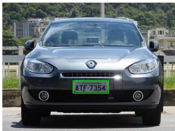
Figura 2 - Resultado do processamento e obtenção do retângulo referente a placa.
