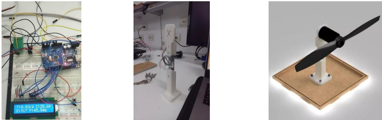
Figura 1 - a) Extração de dados; b) Estrutura da célula de carga; c) Estrutura geral (simplificada).
