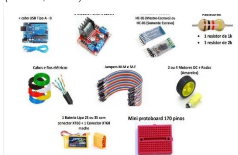
Figura 4 - Componentes do robô. (Costa, 2023)
