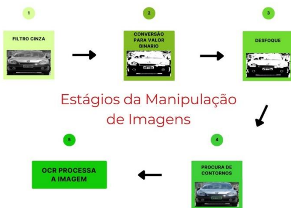
Figura 1 - Passo a passo do processo de tratamento da imagem original antes de ser processada e obter o valor da placa.
