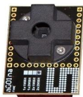
Figura 1 - Placa de desenvolvimento as7341
