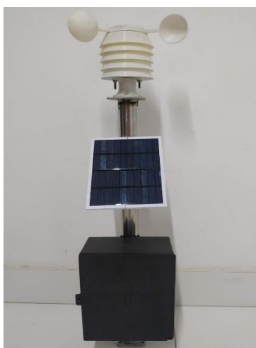
Figura 2 - Protótipo da Estação Meteorológica Automática (Autores).
